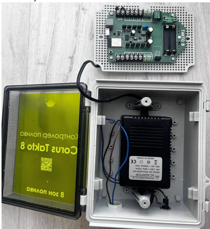
Открутите колпачок сальника. Протяните провода во внутрь корпуса пульта полива для дальнейшего монтажа.
